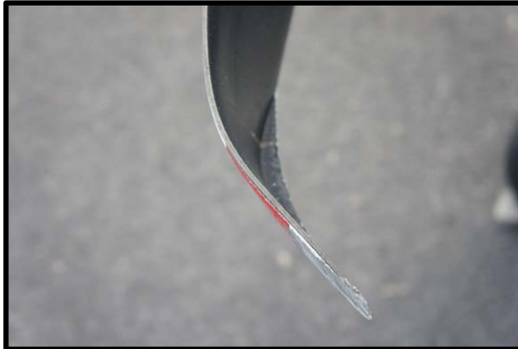
Fotografía No. 9 Vista de la siguiente aspa de la helice dañada.
