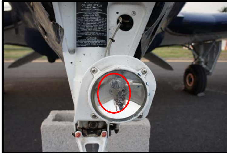
Fotografía No. 5 Vista de daño en Lámpara Luz de Aterrizaje.
