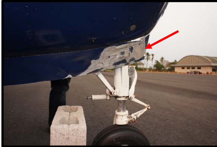
Fotografía No. 3 Daños en la Compuerta del Tren Delantero.
